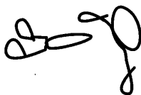
線夾(2) (用於固定排水管接頭)
